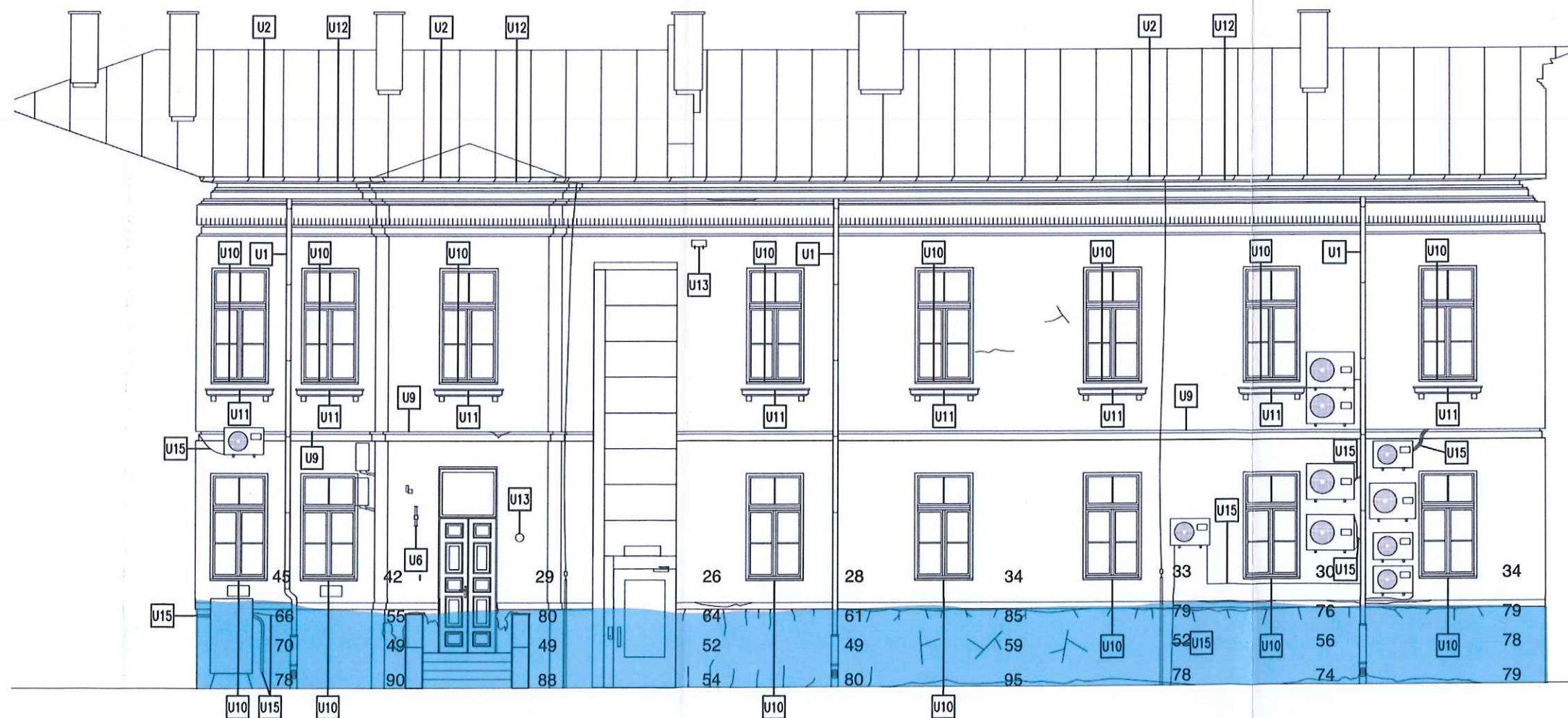
Rys. 6. Rozkład zawilgocenia na ścianach zewnętrznych. Pomiar wykonany metodą dielektryczną do głębokości 10 cm. Kolorem niebieskim zaznaczono orientacyjnie strefę zawilgocenia. Wartości poniżej 45% charakteryzują mur powietrzno-suchy.
